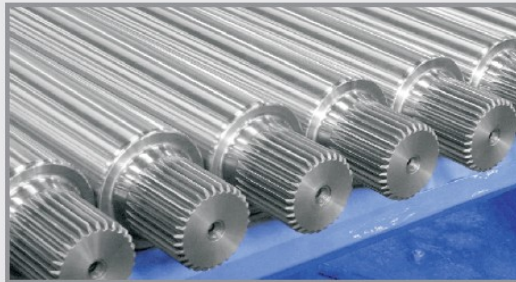
Intermediate rolls - drive rolls Aussenzwischenwalzen - Antriebswalzen
