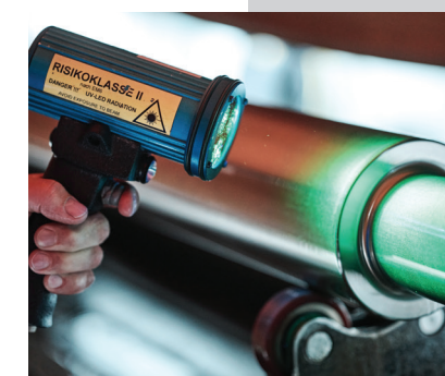
Magnetic particle inspection for surface errors / Magnetpulverprüfung für Oberflächenfehler
