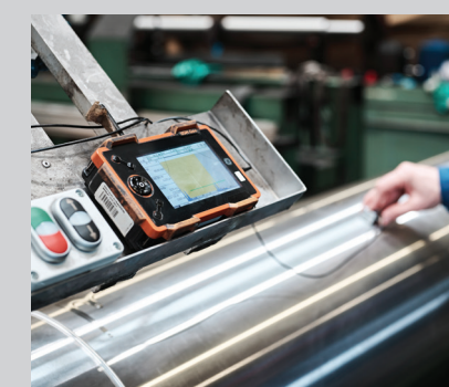
Ultrasonic inspection for material defects / Ultraschallprüfung für Fehler im Stahl
